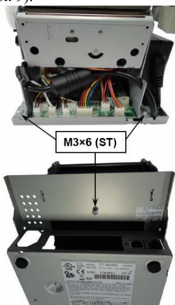
Рисунок 9 Винты крепления механизма к консоли системной платы
