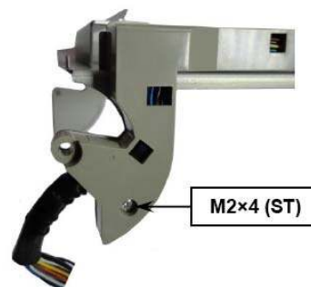
Рисунок 14 Снятие кожуха центрального кабеля
