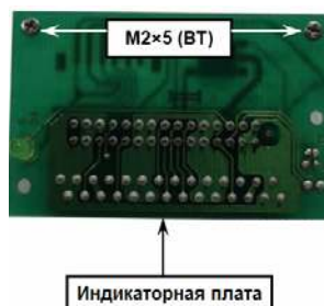
Рисунок 19 Крепление LED-панели на индикаторной плате
